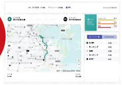
各ドライバーの走行ごとに、危険運転発生場所、運転スコア、運転傾向を把握する分布図データを可視化。急ハンドル、急加速、急減速等を減らし事故率低下、積荷破損率軽減実現。
